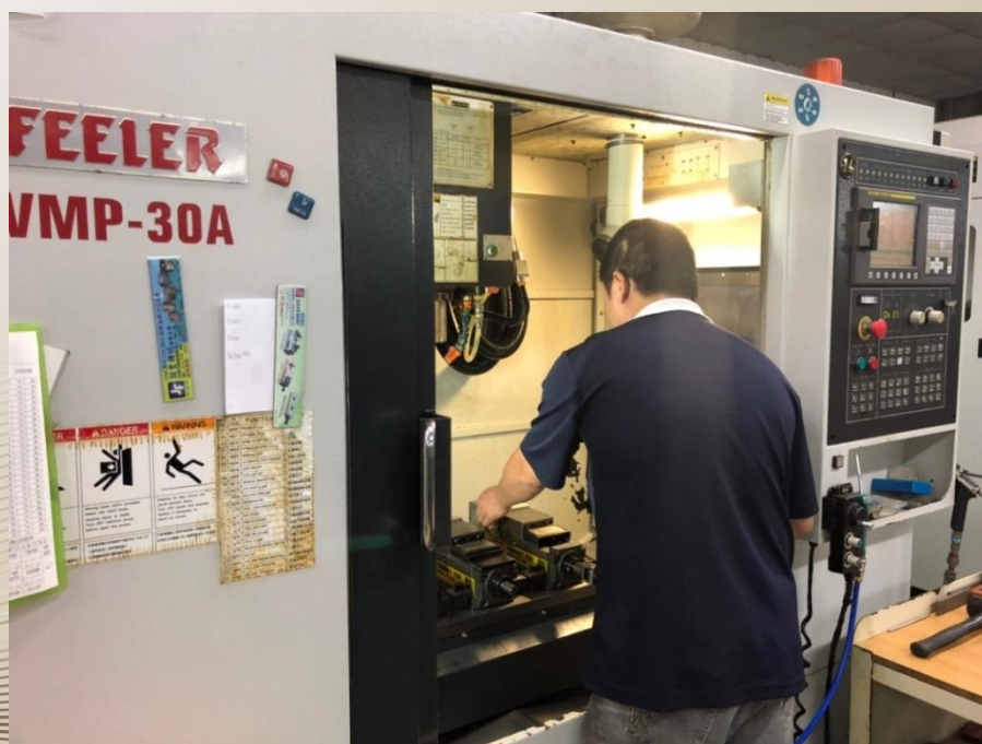
FEELER VPM-30A 主軸轉速10000 最大加工行程X750 Y410 加工精度0.005mm
