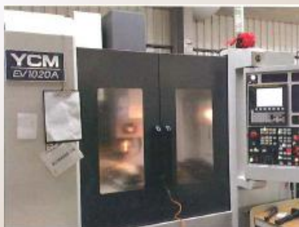
YCM EV-1020A 主軸轉速10000 最大加工行程X1020 Y520 加工精度0.005mm
