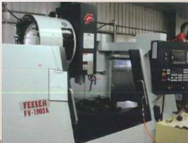
FEELER FV-1000A 主軸轉速10000 最大加工行程X1020 Y500 加工精度0.005mm
