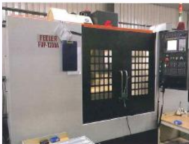
FEELER VVP-1300A 主軸轉速10000 最大加工行程X1300 Y550 加工精度0.005mm
