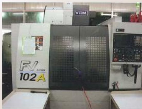
YCM FV-102A 主軸轉速10000 最大加工行程X1020 Y520 加工精度0.005mm
