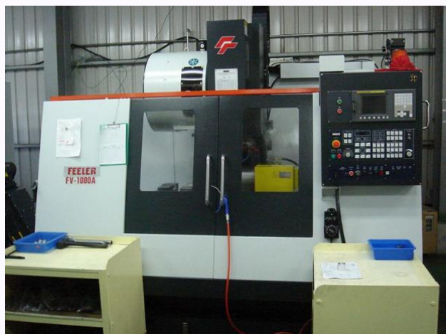
FEELER FV-1000A 主軸轉速10000 最大加工行程X1020 Y500 加工精度0.005mm
