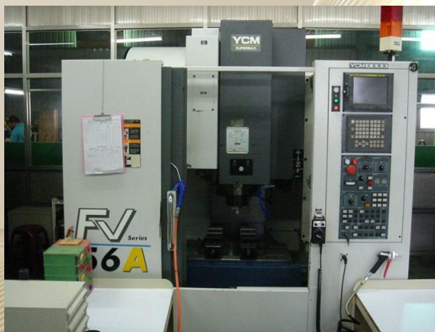
YCM FV-56A 主軸轉速10000 最大加工行程X500 Y400 加工精度0.005mm
