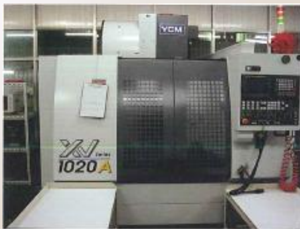
YCM XV-1020A 主軸轉速10000 最大加工行程X1020 Y520 加工精度0.005mm
