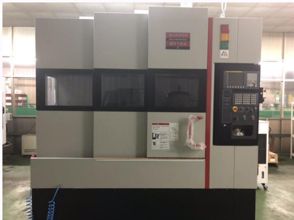
MV184D/12C 主軸轉速12000 最大加工行程X1024 Y610 加工精度0.005mm
